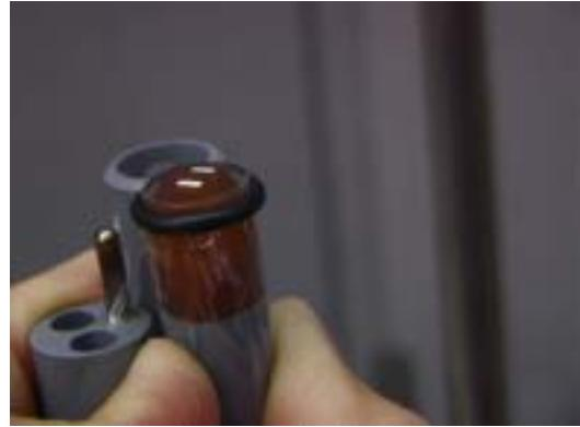
安装一个新的 O-圈：将 O-圈的一边放入槽中，将圈绕过膜，并把圈的另一边套在探头的另一侧槽中。必须防止手指接触到探头的表面。O-圈套上以后，将其每 90 度挤压一次以使拉力平衡。不允许在 O-圈上使用油脂或任何类型的润滑油。
