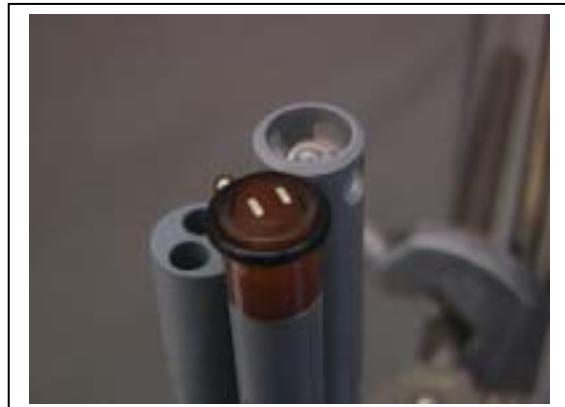
如果已经正确安装，最终的探头应该如图 13 所示那样没有气泡、皱褶或裂缝。
