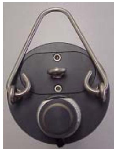
对于 6600 和 6000upg，将锌阳极置于多参数仪主机连接器的上面，在阳极的底部和多参数仪的顶部留一个小缝隙，您可以利用包装材料带夹在其中产生缝隙（如上图 4）。确保锌阳极的平头端在连接器的电池盒一侧，阳极安装在如图 5 所示的电线下面。
